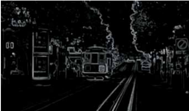
Figur 3. Sobel-filter (vänster) och Harris Corner Detector (höger) används vid bildbehandling för att detektera kanter och hörn.
