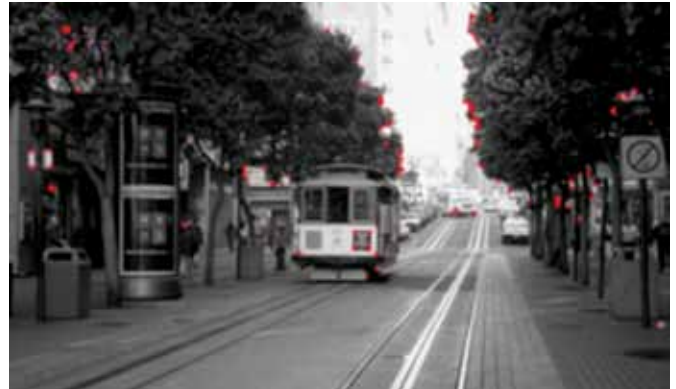
Figur 3. Sobel-filter (vänster) och Harris Corner Detector (höger) används vid bildbehandling för att detektera kanter och hörn.
